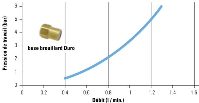
**Puissance de pulvérisation buse réglable 1.3 mm**
