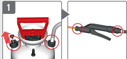
Verbindungen und Überdruckventil überprüfen
