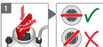
Pumpe korrekt entriegeln
