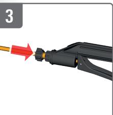
Pulverrohr an Handventil schrauben
