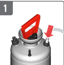
Schlauch an Druckbehälter schrauben
